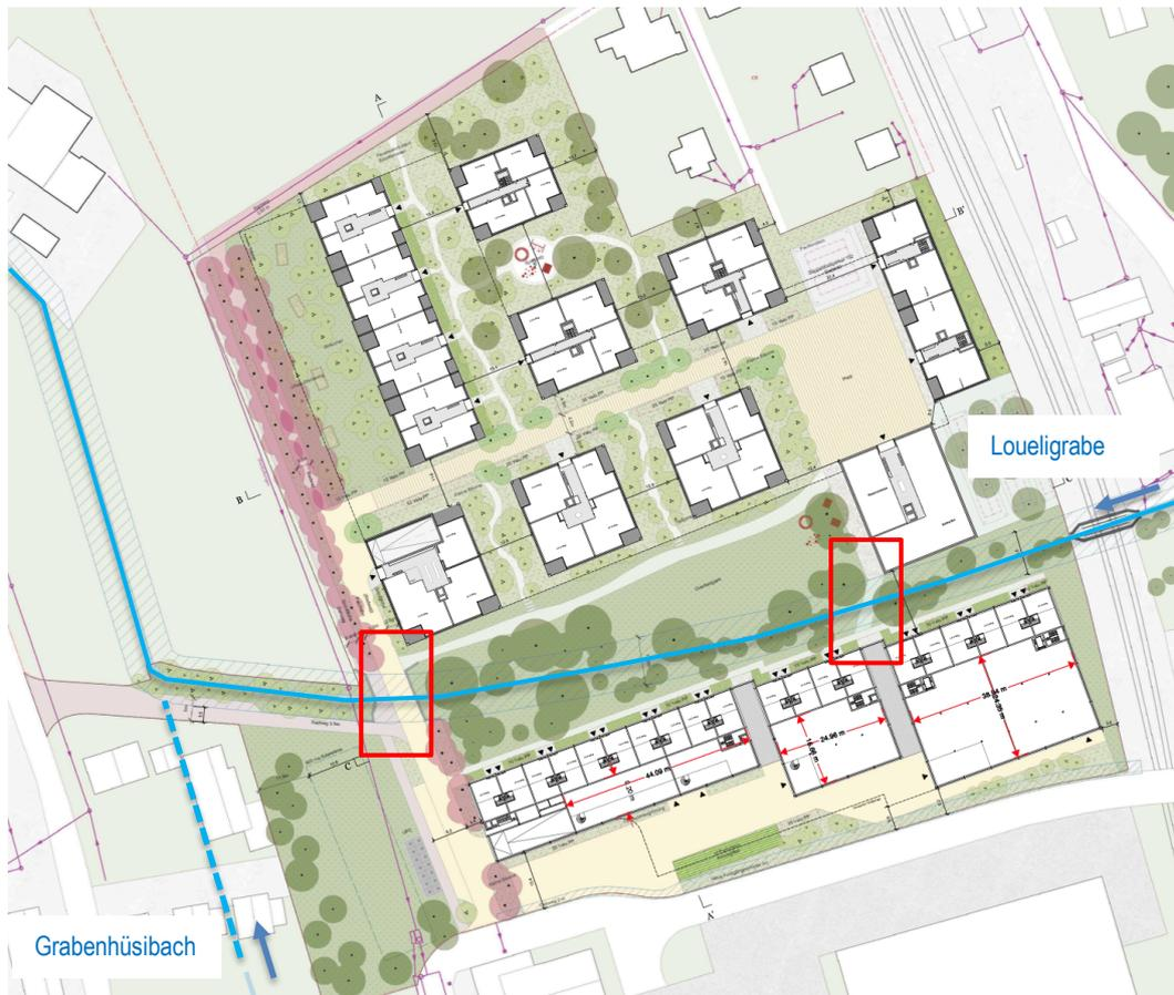
Abbildung 1: Ausschnitt aus den Projektunterlagen des Richtprojekts. Loueligrabe (blau), Brücken gemäss Projekt (rot). Linke Brücke: Hauptverkehrsbrücke, rechte Brücke: Fussgängerbrücke.
