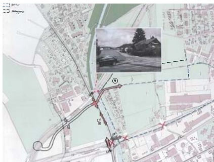
Abb. 6 Variante 4: Erschliessung mit Zulgbrücke bei Autobahnzubringer mit Anschluss Glättimülkreisel, Schliessung Bahnübergänge und neue LV-Brücke Zulg
